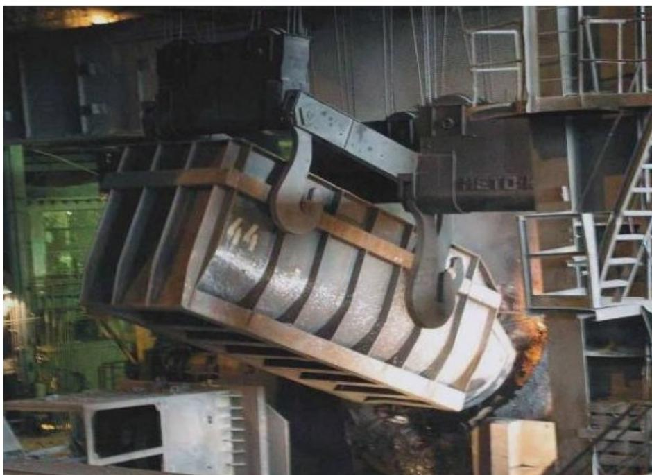
Рисунок 3 – Завалка металлического лома в конвертер
